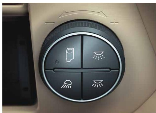
Zakretnim prekidačem upravlja se odabirom svjetala i njihovim prigušivanjem.
