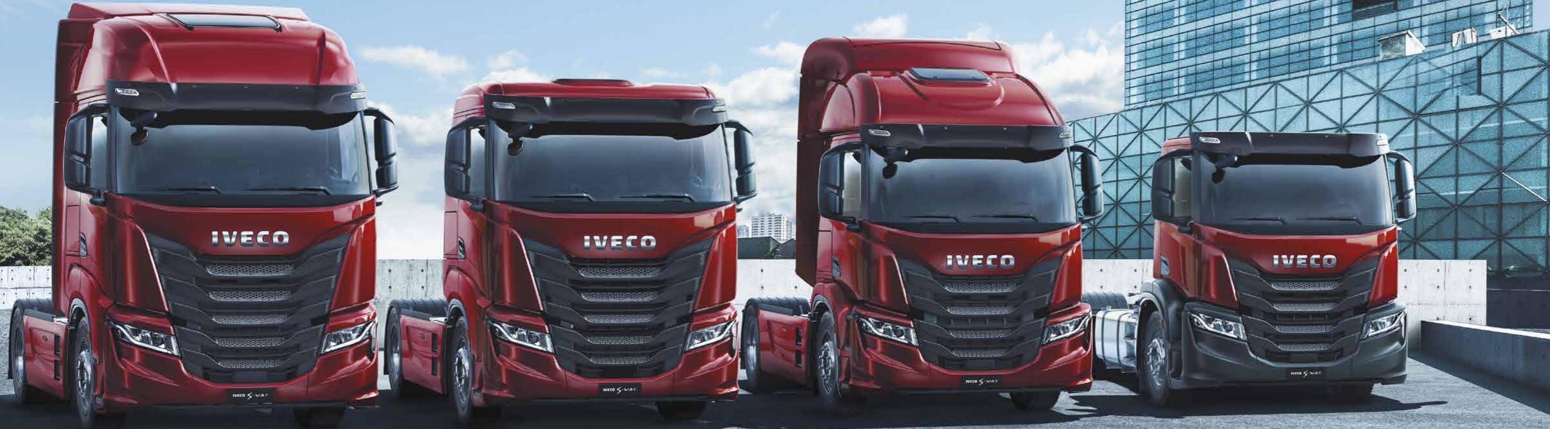
Ponuda kabina IVECO S-WAY nudi odabir kabina u skladu sa svim zadacima: kabina za spavanje **AS**, kabina za spavanje **AT** s niskim ili srednjim krovom te kratka kabina **AD** s niskim krovom.
